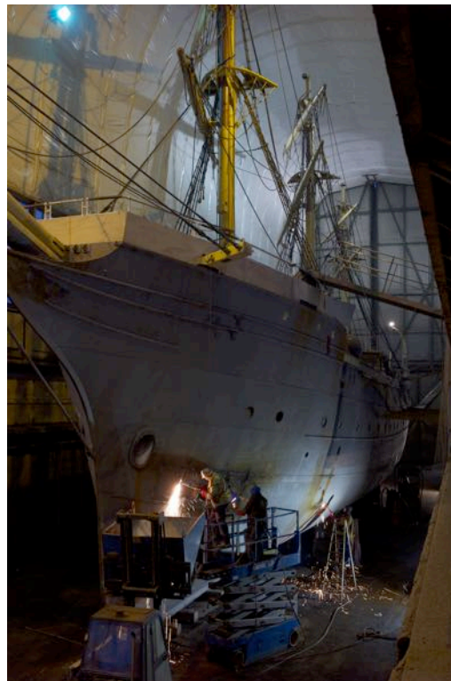
Billede 3- Der arbejdes med stålet i Assens værfts overdækkede flydedok
